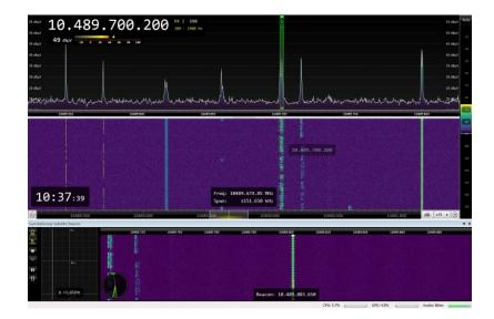
Erwin, OE5VLL, zeigt wie die Frequenzanzeige beim SDR-Console-Programm mit dem QO-100 Bake-Signal synchronisiert wird
