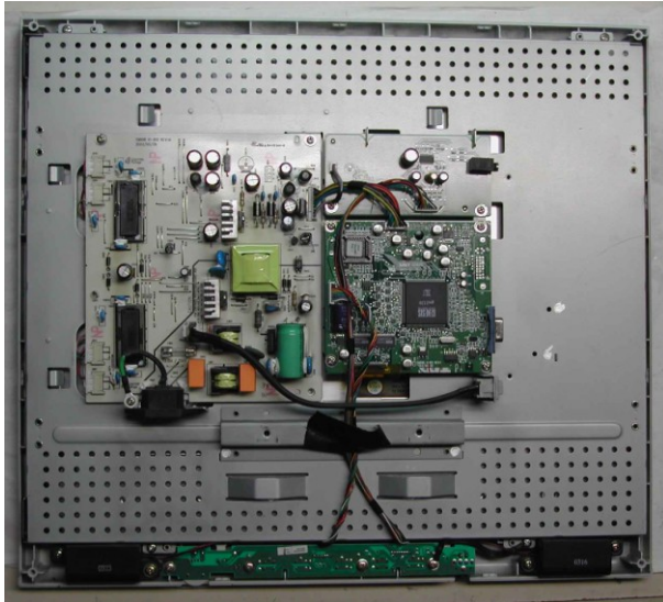
Abb. 3: Typische Innenansicht eines LCD-Bildschirms
