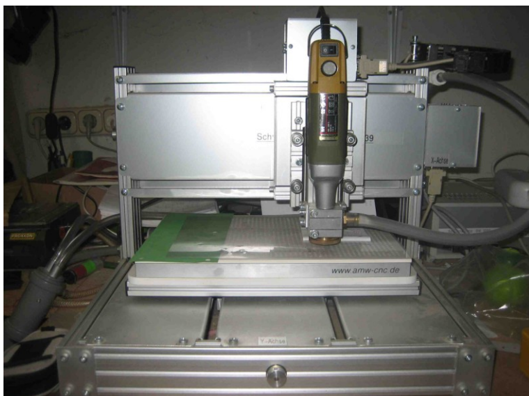
Abb. 8: NC-Fräse mit einem Arbeitsbereich in der Größe von A4
