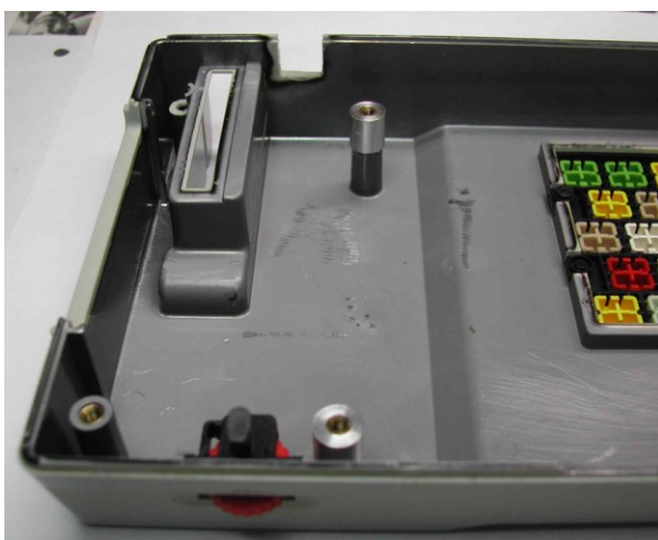
Abb. 5: Ein originaler, ein defekter und zwei reparierte Befestigungspunkte
