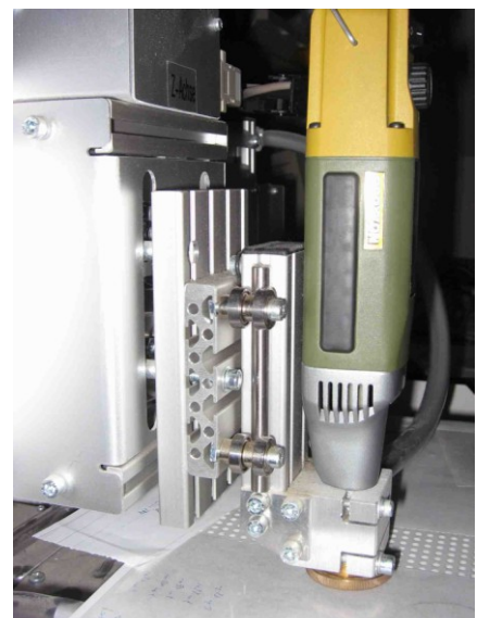
Abb. 9: Vertikalschlitten mit Frässpindel
