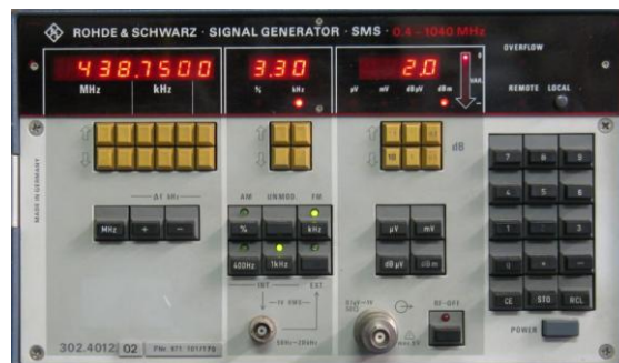
Bild_05: Der SMS Signalgenerator
