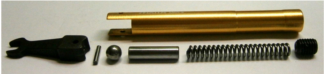
Abb. 1: Einzelteile des Schlüssels von links nach rechts
