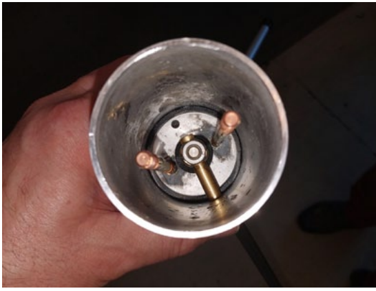
die aufgeschraubte Sirio-Antenne mit Wasserschaden
