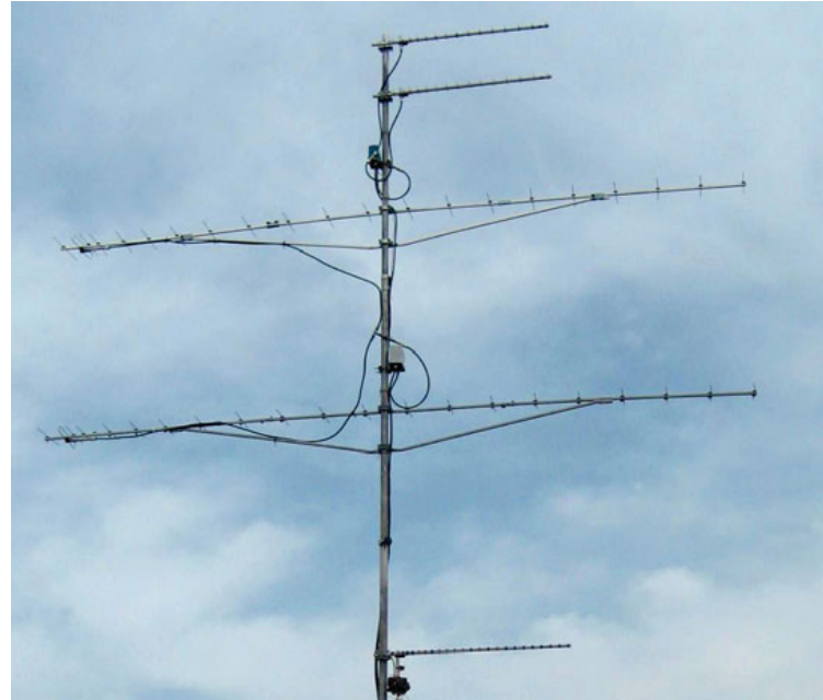
Die portable Antennenanlage von OE8FNK im Alpe Adria Kontest 2021, 70cm: 2x 21el Yagi, 23cm: 2x16el Yagi, jeweils mit Vorverstärker
