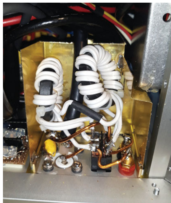
Bild 5: der 1:4-Balun, geschirmt in einem Ms-Gehäuse
