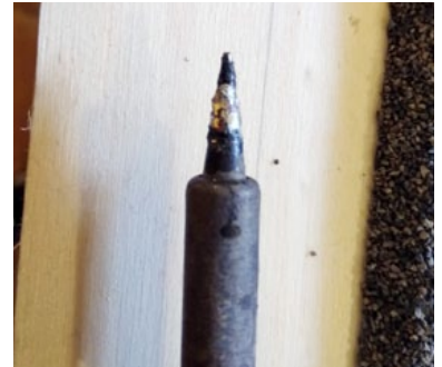
verschmutzte Lötspitze – technisch OK, muss nur gereinigt/abgestriffen werden
