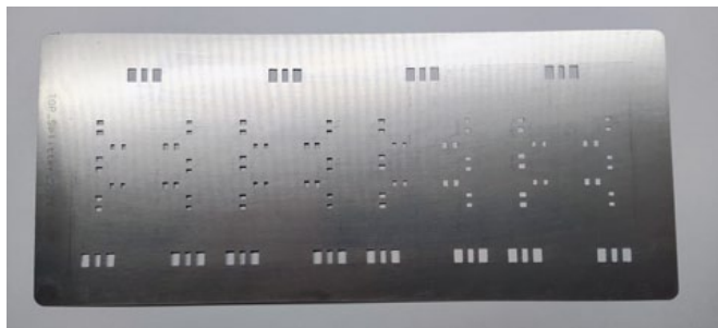
SMD Lötpasten Schablone für 2m/70cm Splitter
