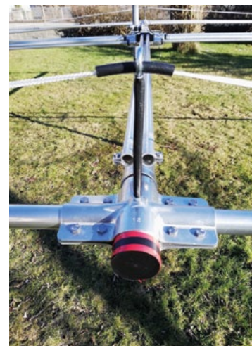
rechts: die montierten Abspannungen der Elemente
