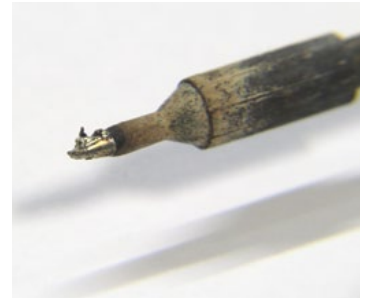
verschmutzte Lötspitze – technisch OK, muss nur gereinigt/abgestriffen werden
