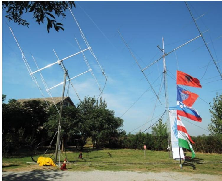
Unsere EME-Antennen: links 4x9el-144 MHz-Antennen, Länge 5 m und rechts 2x8el-50 MHz-Antennen, Länge 10 m
