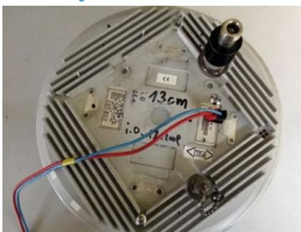
die Bodenplatte mit heatsink von unten
