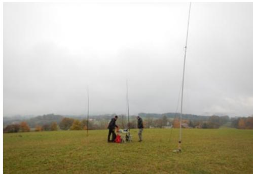
Delta Loop und Triple Leg Groundplane mit 2m-J-Pole in der Mitte
