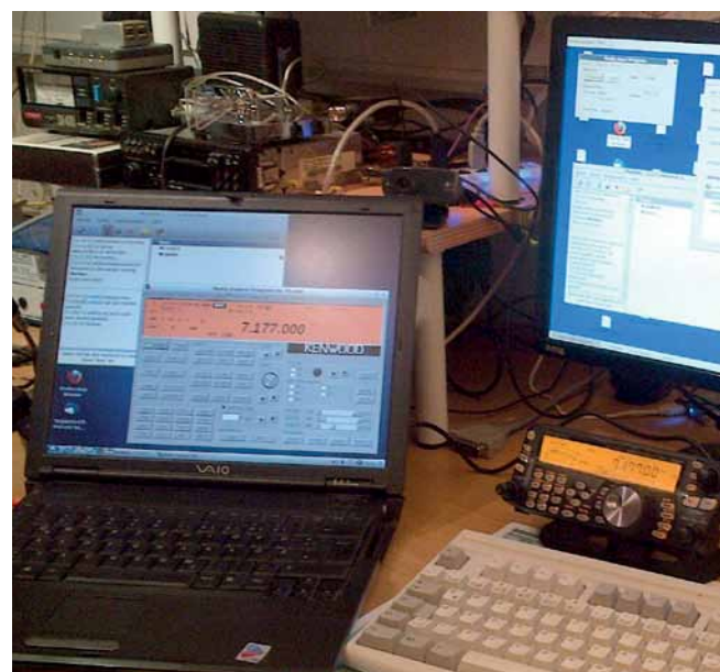
Bild 2: Remote-PC (links) und Shack-PC (rechts), der mittels RS-232 und Signalink-USB (nicht im Bild) mit dem Kenwood TS-480SAT verbunden ist (Bedienteil rechts)
