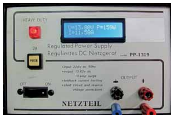
in vorhandene Netzgeräte nachträglich eingebaute Module
