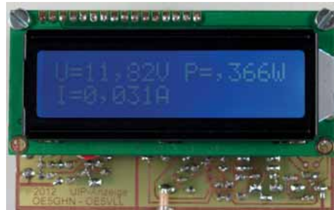
Das Spannungs-Strom-Leistungsanzeige-Modul mit blauem LCD
