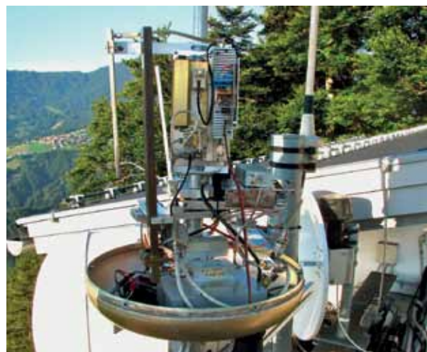
TX1 mit 4 W PA, TX2, TX3, Empfangsfilter im Random
