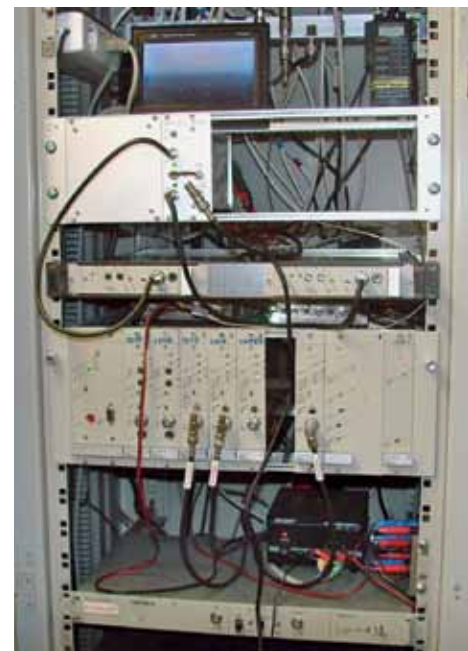
Satreceiver für RX1 und Links von OE9XTV und DB0UTZ Videoprozessor für Camera und Testbild
