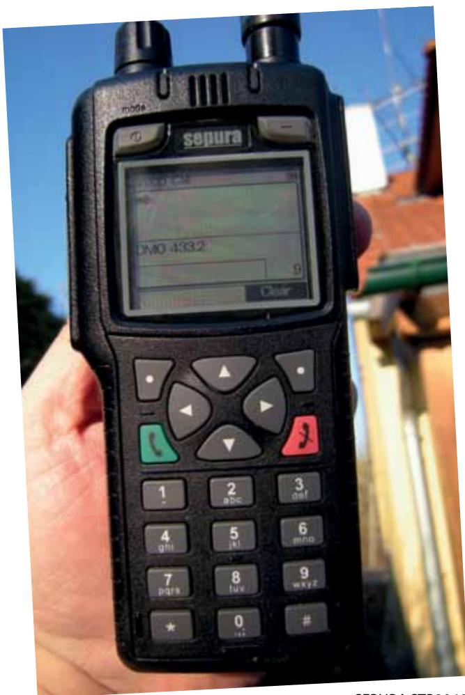
SEPURA STP8040 TETRA Handfunkgerät, 1,8 Watt 433 Mhz, DMO Mode
