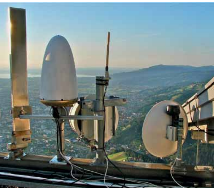
Antennen von links 23 cm-Schlitzantenne, Random, 24 GHz-Spiegel Link von Fussach, Rundstrahler für Phoniezugang, 60 cm Spiegel Link von DB0UTZ
